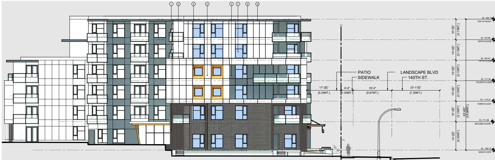
1 SOUTH ELEVATION SCALE: 1/8" = 1'-0"
