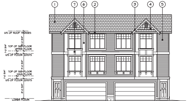
SOUTH ELEVATION SCALE: 1/8" = 1'-0"
