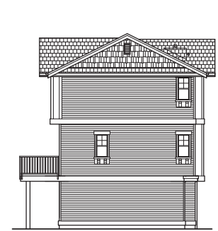
WEST ELEVATION SCALE: 1/8" = 1'-0"
